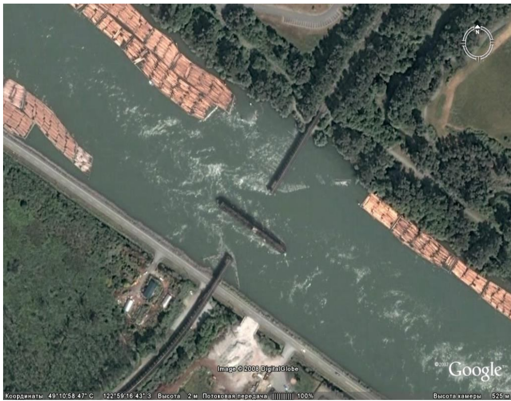
Рис. 5. Мост вертикальной разворотной компоновки. Ричмонд, Канада
