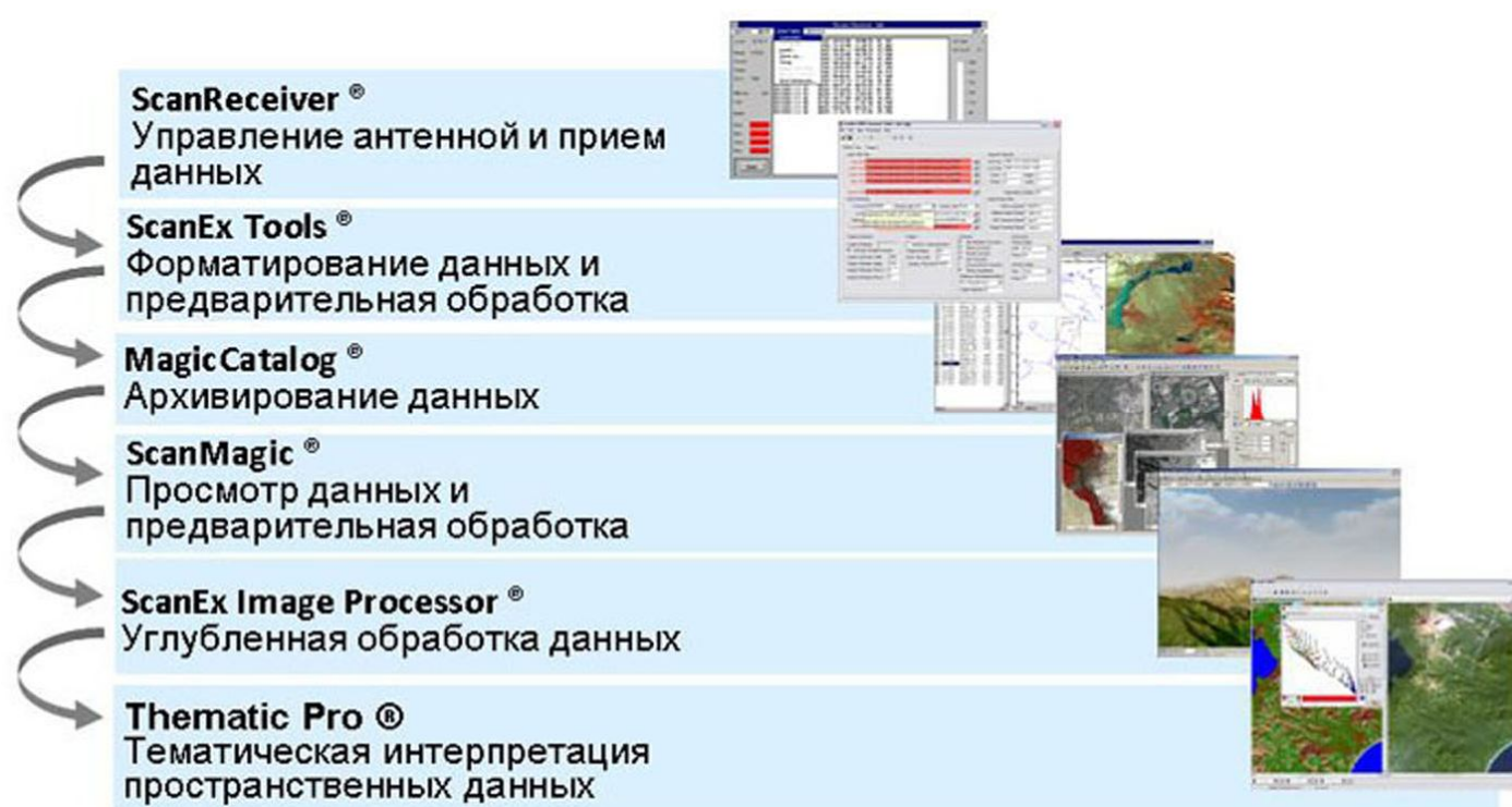
Рис. 6. Программные средства для приема, обработки и хранения спутниковых данных (данные ИТЦ СканЭкс)
