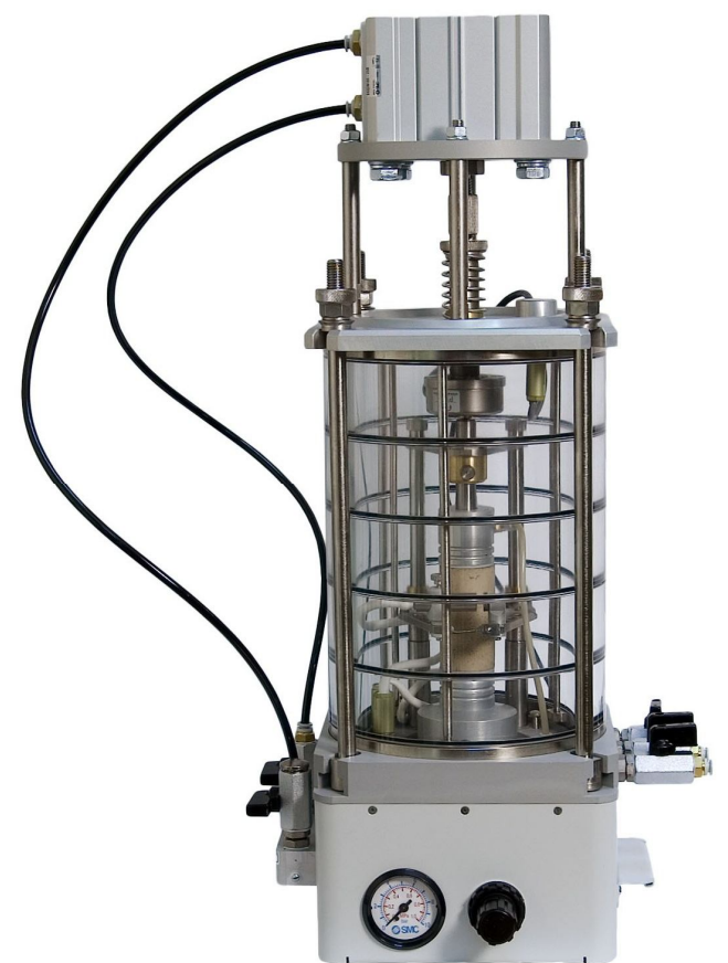
Рис. 3. Стабилометр — прибор трёхосного сжатия.
