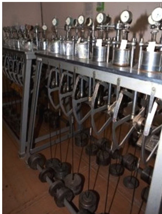
Рис. 2. Компрессионные испытания грунтов в одометрах.
